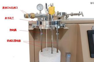
VEF-1700 是一款电解炉，最高温度 1700°C，炉管是氧化铝管（内径 74mm），配有 3 根石墨电极，此款设备可在气氛控制环境下探索熔盐。
