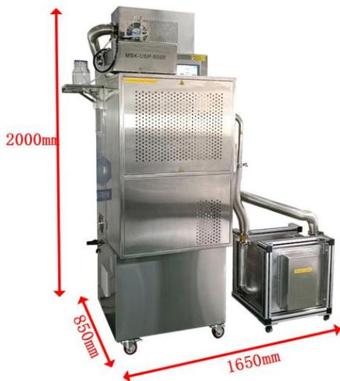
MSK-USP-6000-HT 是一款实验型雾化干燥机和雾化热解造粒机，最高温度可达 450℃，将液体前驱体雾化后通入到干燥腔内液体蒸发干燥后得到较好的固体，也可将液体雾化后再高温环境下热解形成固体颗粒。此套设备特别适合合成一些热敏感性材料，应用纳米技术、催化、燃料电池和电池等行业。
