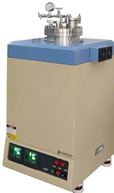
VBF-1200X-H 高温炉是以电阻丝为加热元件，耐热不锈钢为腔室，采用欧陆仪表进行控温，控温精度可达 $\pm 0.1^{\circ}\text{C}$ ，真空度可到 10-5Pa，可以在一个相对洁净的环境下对样品进行各种高真空、气氛和还原处理。
